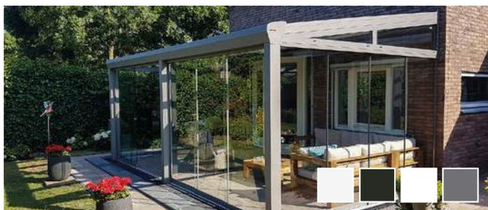
SUPREMELINE, Stabile Rinnenousführung: Pfostenabstand bis zu 6 m, variable Dachneigung 5-15°, Wasserablauf unsichtbar im Pfosten integriert, Dacheindeckungen: Polycarbonat 16 mm oder 8 mm Glaseindeckung (VSG), Rinne und Wandanschluss aus einem Stück (bis 7 m Breite)
