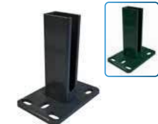
Montagefüße für Pfosten 60 x 40 mm zum Aufschrauben auf festem und ebenen Untergrund. 150 x 100 x 8 mm
